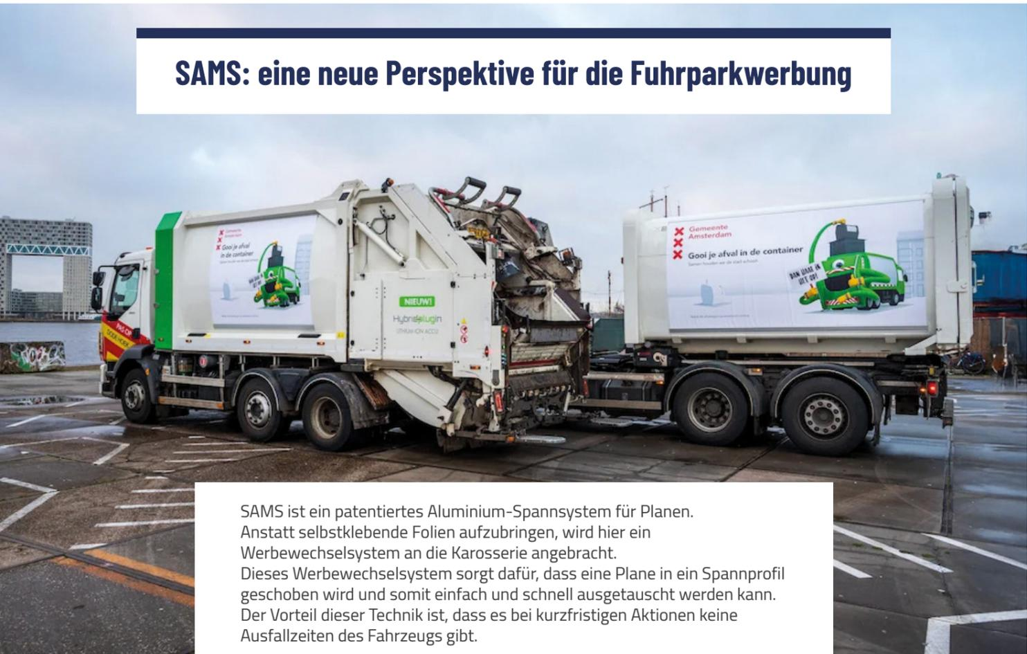
SAMS ist ein patentiertes Aluminium-Spannsystem für Planen. Anstatt selbstklebende Folien aufzubringen, wird hier ein Werbewechselsystem an die Karosserie angebracht. Dieses Werbewechselsystem sorgt dafür, dass eine Plane in ein Spannprofil geschoben wird und somit einfach und schnell ausgetauscht werden kann. Der Vorteil dieser Technik ist, dass es bei kurzfristigen Aktionen keine Ausfallzeiten des Fahrzeugs gibt.
